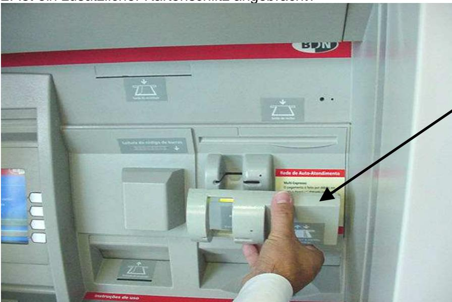
Falscher Kartenschlitz über dem Original angebracht. Enthält einen zusätzlichen Magnetstreifenleser um eine Kopie der vorhandenen Daten zu erstellen.
